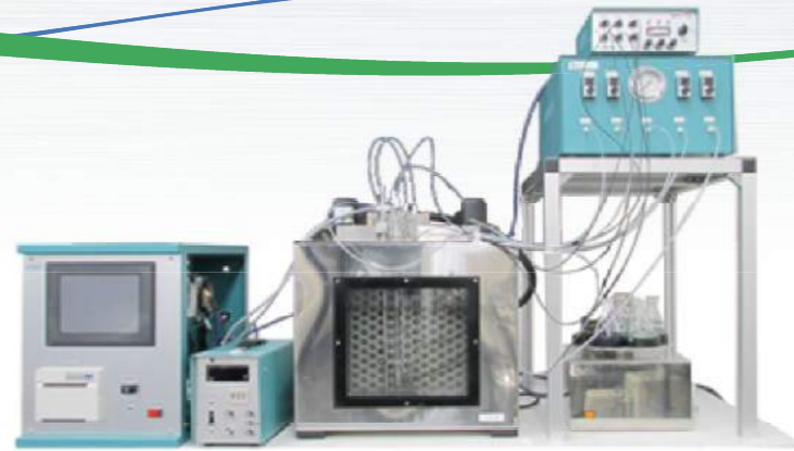
粘度管はウペローゼ改良型（専用特注品）。
