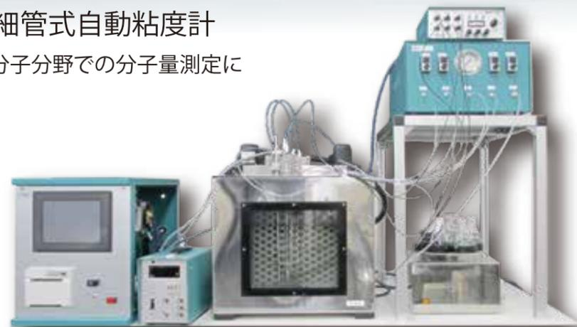
ポリマーの分子量を測定、JIS規格に準拠。粘度管はウベローゼ改良型（専用特注品）。
