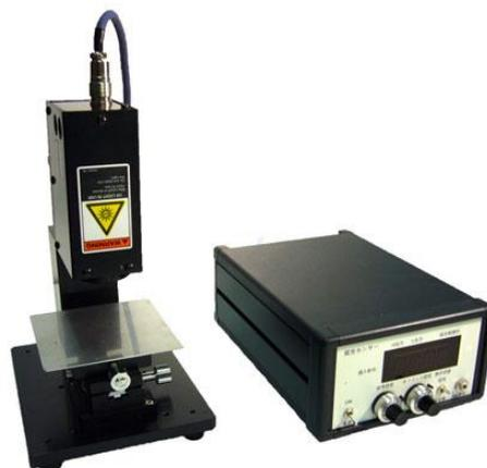
図4 UV硬化度測定装置外観
