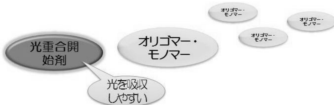
図 3-1 UV 硬化樹脂の構成
