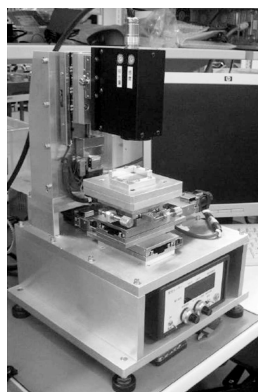
写真1 光ピックアップ接着箇所計測システム
