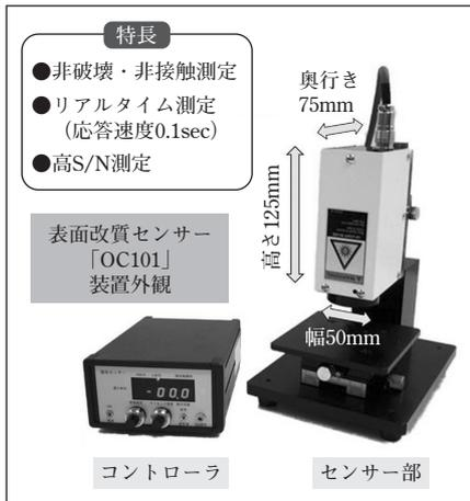
図1 表面改質センサーの装置全体図
